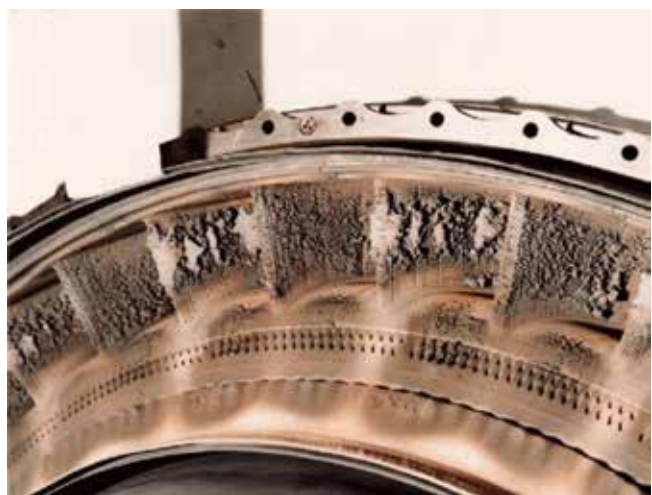
图4 火山灰严重损坏飞机发动机
